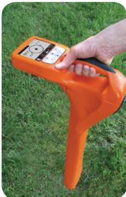
尋測器使用高科技數位技術，可提供你管子正確位置及深度。透過發送機訊號得到 100 個靈敏水準度。LCD 顯示板產生一個清楚數位讀取，同時顯示一個圖形及音調。比起類比式尋測器，其速度更快且準確度更精準。它擁有更大電力及功能範圍，比起其他任何世面上的尋測器。
